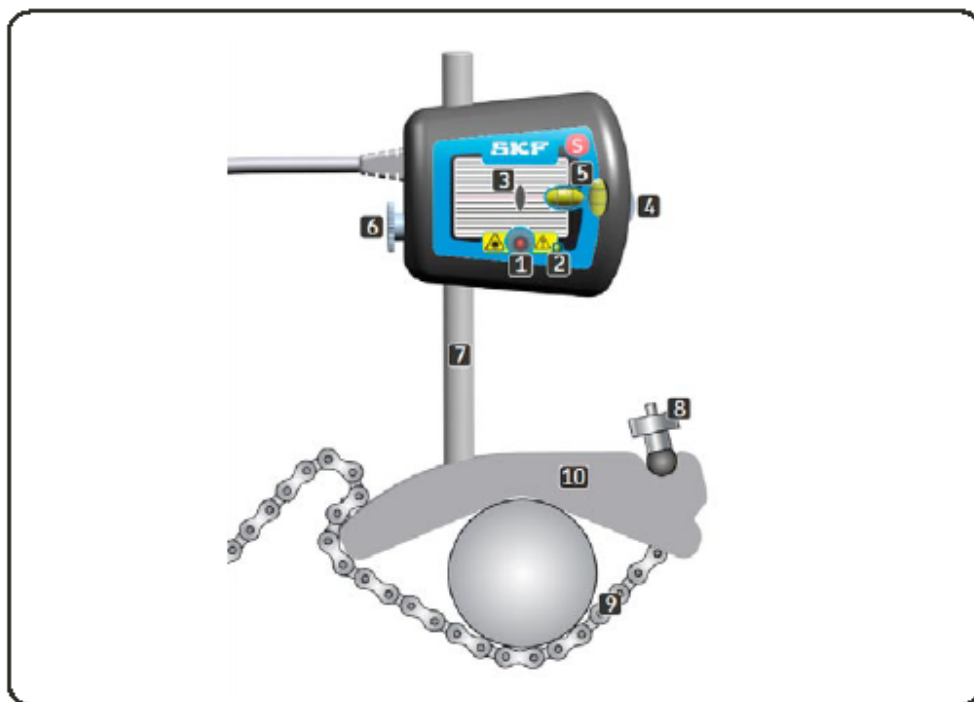
Рис. 7. Магнит /Механическое крепление измерительного блока
