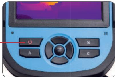
Рисунок 6 Включение тепловизора
