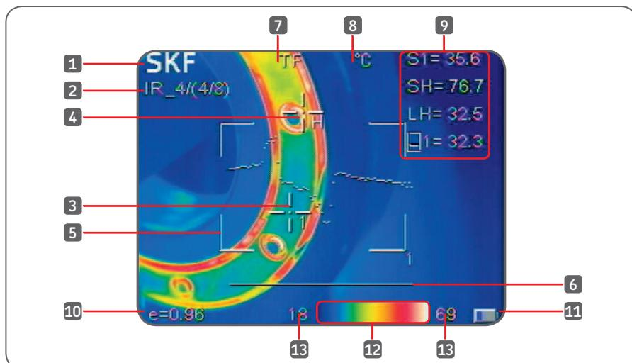
Рисунок 15 Элементы экрана
