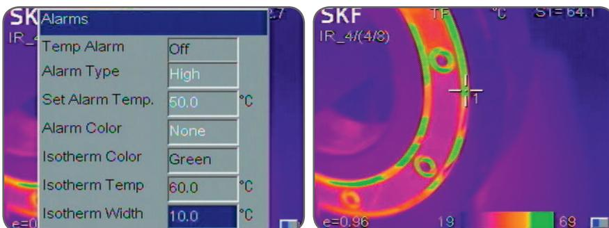
Рисунок 28 Аварийные сигналы и изотермы
