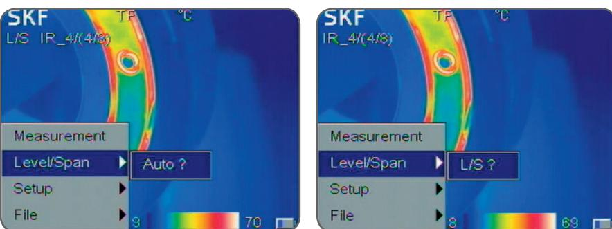
Рисунок 17 Автоматический или ручной режим
