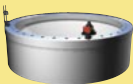
Плоскостность кольцевых плоскостей (например, фланцев).
