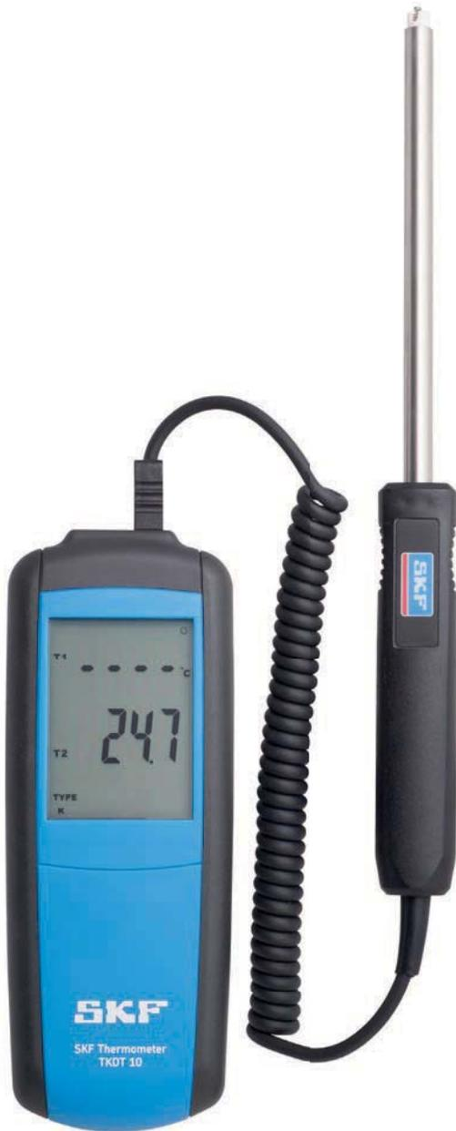
Точное двухканальное измерение температуры.
