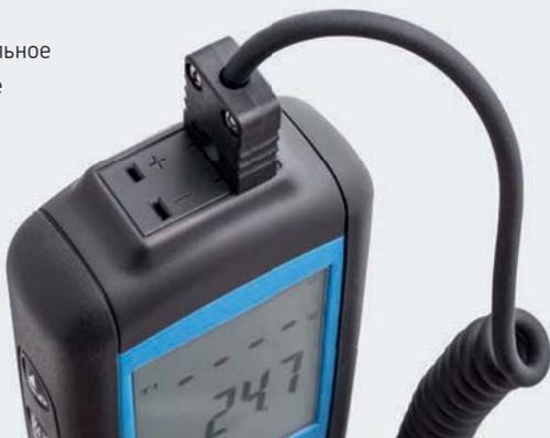
Измерение разности температур между датчиками
