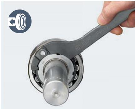
Четыре ключа позволяют затягивать гайки 24 размеров
