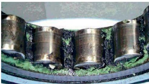
Деградация смазки, вызванная прохождением электрического тока
